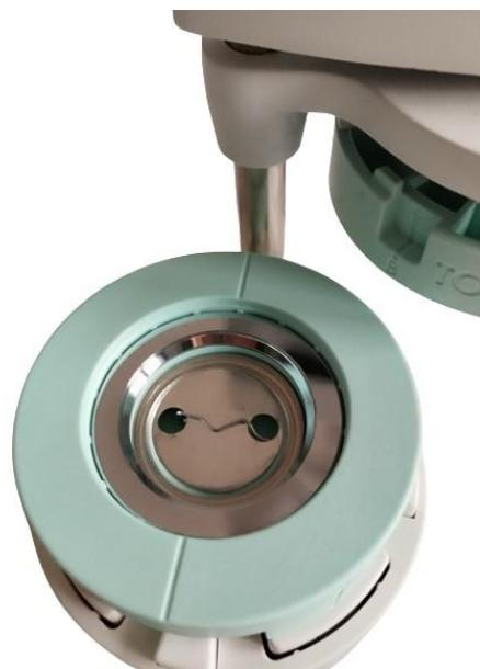
Xira a base ata deixala debaixo do molde superior. Agora move a peza superior para que o triángulo quede apuntando ao B. Move a base ata colocada debaixo do molde superior. Xira a peza inferior para colocar o B debaixo do B superior.
