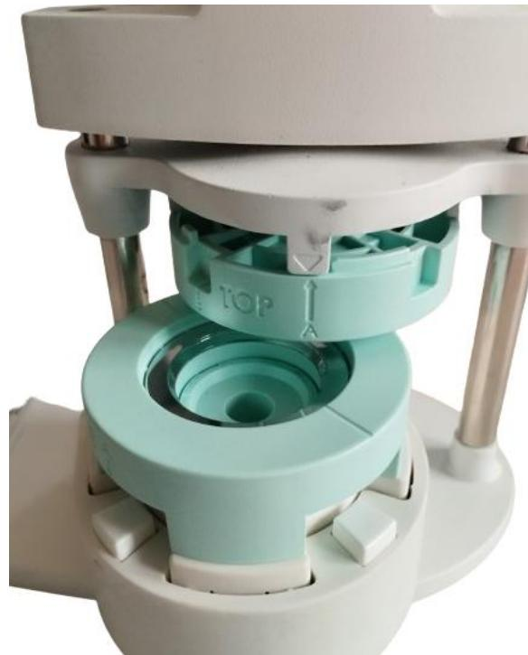
Despois de separar a base, coloca a parte inferior da chapa, coa parte do broche que abre e pecha, pegada ao molde. Usa as liñas do molde para que quede centrada.
