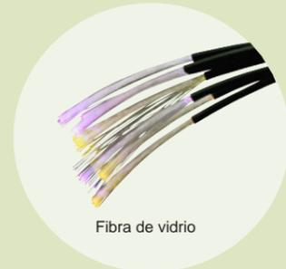
Para obtener fibra de vidrio, el material fundido se estira hasta lograr filamentos muy pequeños que funcionan como aislantes eléctricos. Actualmente, el vidrio flotado, plano, se destina a edificios y ventanas.
