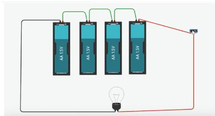
NOTA: para conectar las pilas en serie debes unir el polo positivo con el negativo de la siguiente pila y así sucesivamente, de acuerdo con el siguiente esquema:
